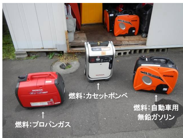
写真9 防災用ポータブル発電機
