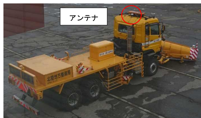
写真6 アンテナ設置箇所
