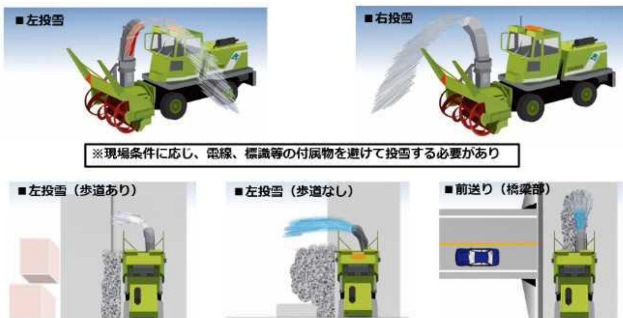
図-10 シュート投雪の自動化イメージ
