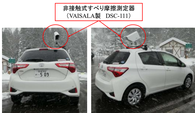
図 1 1 車両に搭載した非接触式すべり摩擦測定器
