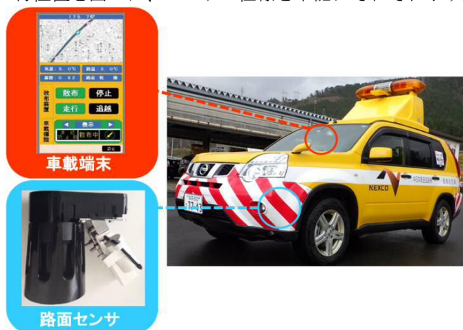
図3. 道路巡回車の路面センサ構成
