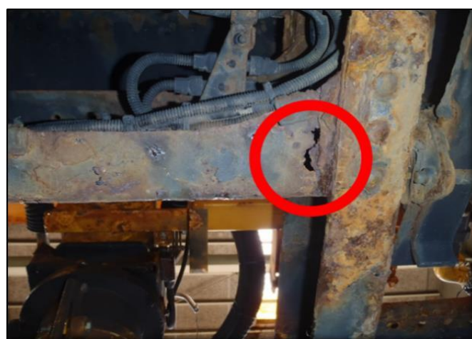
写真-2 シャシ後部サブフレーム穴あき状況
