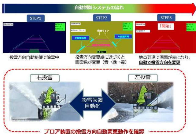
図-9 ブロア装置の投雪方向自動制御
