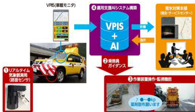
図10. 雪氷作業支援システムの全体イメージ
