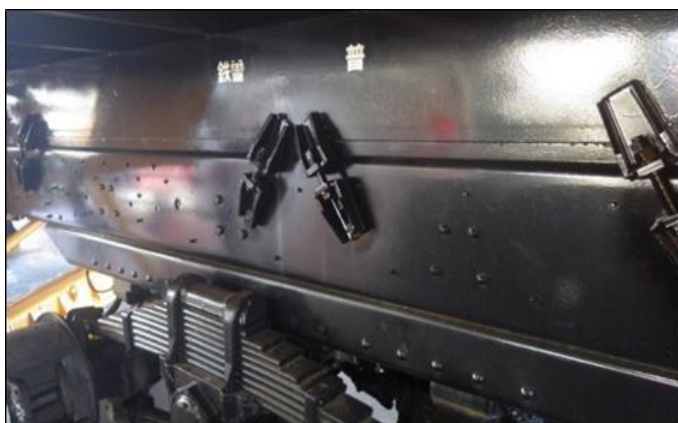
写真-7 塗料B 除雪専用車シャシフレーム外側状況
