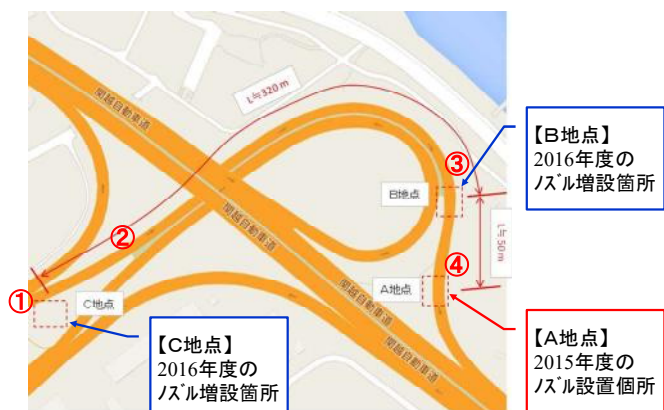
図7 散布箇所の増設状況と路面観察箇所
