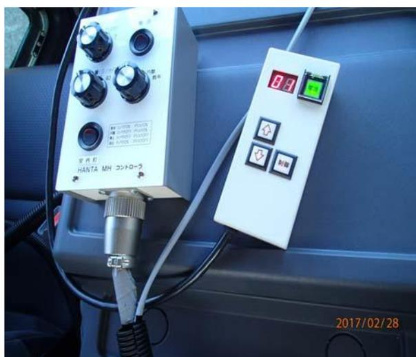
写真 4 小型散布機制御リモコン
