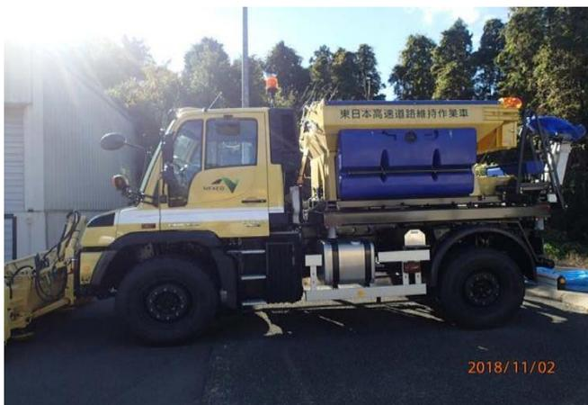
写真 5 純正散布装置
