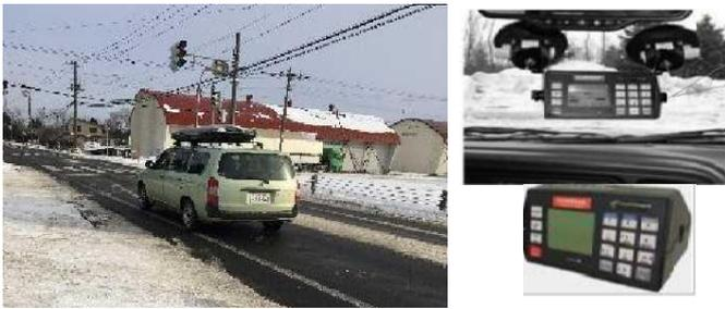
図. 3 路面摩擦係数測定方法と測定計
