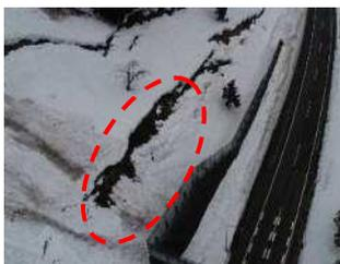
写真6 石打TN東京側坑口堆雪ポケット (UAV撮影)
