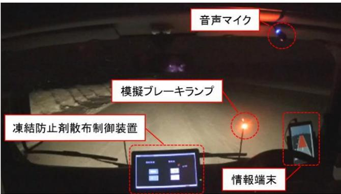
写真2 試験車両内に設置した各種機器
