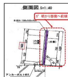
写真6 雪庇防止板の設置範囲と板の傾斜
