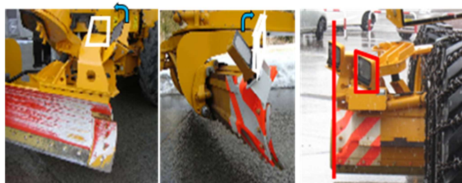
写真-13 ブレードマーカの取付位置変更
