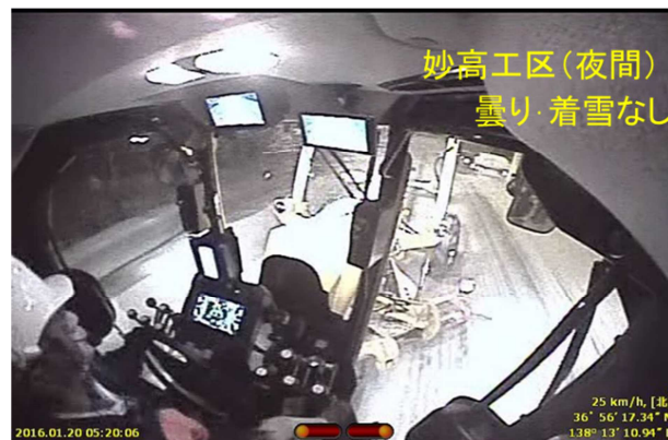
写真-6 運転室内の結露状況 (新型除雪グレーダ)
