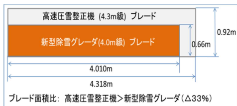
図-6 ブレードの寸法
