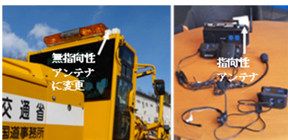
写真-12 通信装置のアンテナ変更
