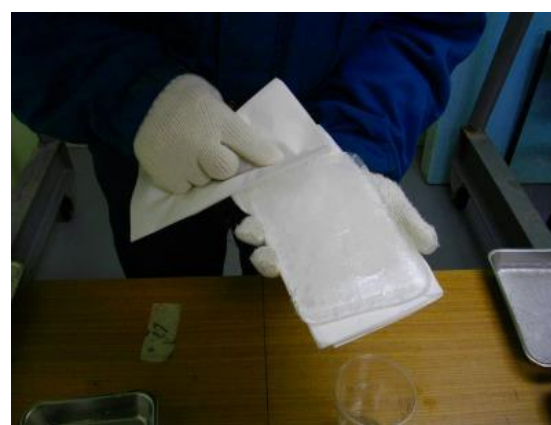
写真2 融出水の吸取り状況
