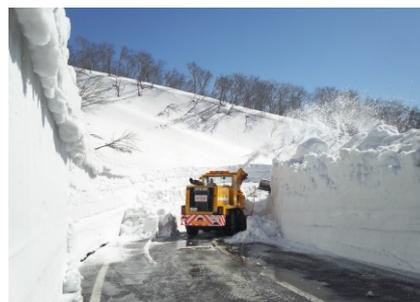
図7. 春山除雪作業（ロータリー除雪車）
