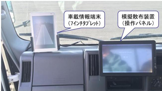
写真2 試験車両の助手席付近に設置した各機器
