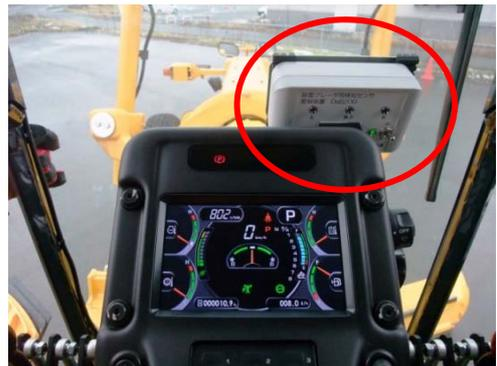
写真-3 オペレータへの通知機器
