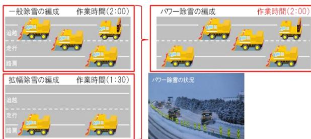
図-3 一般・拡幅除雪とパワー除雪
