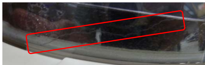
写真－４ 導電膜のクラック状況
