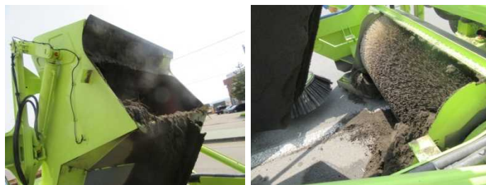
写真－11 装置への塵埃堆積状況
