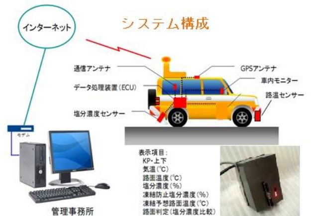
写真3 車載式塩分濃度システム
