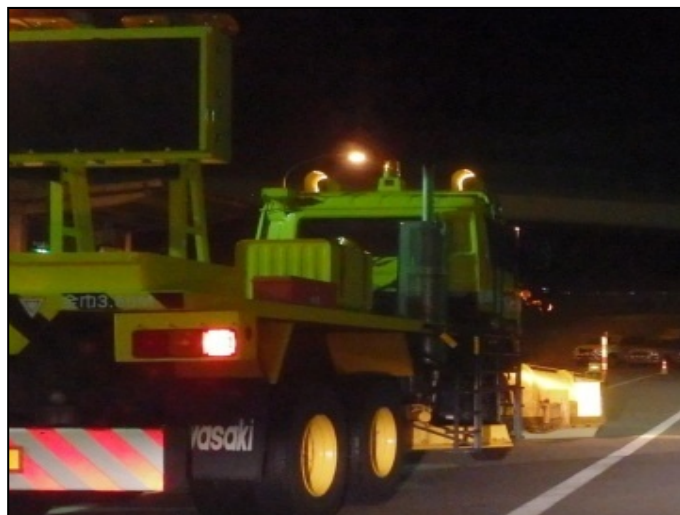
写真7「路肩拡幅車用プラウ照明装置」
