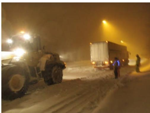
写真-4 トラクターショベルによる後部からの牽引状況
