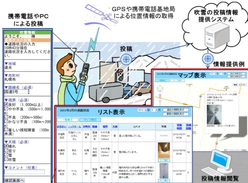
図-7 「吹雪の投稿情報システム」概要図
