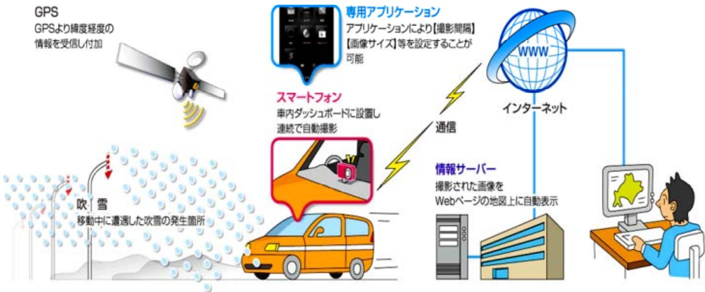
図-8 「道路画像自動撮影投稿システム」概念図
