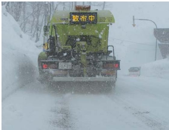
写真6 防滑材散布作業状況（黒着色剤散布）
