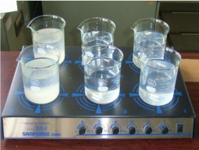
写真-1 溶解試験の状況
