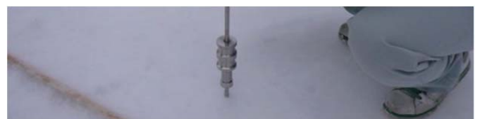
写真-2 雪硬度の測定状況
