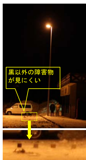
高圧ナトリウム照明
