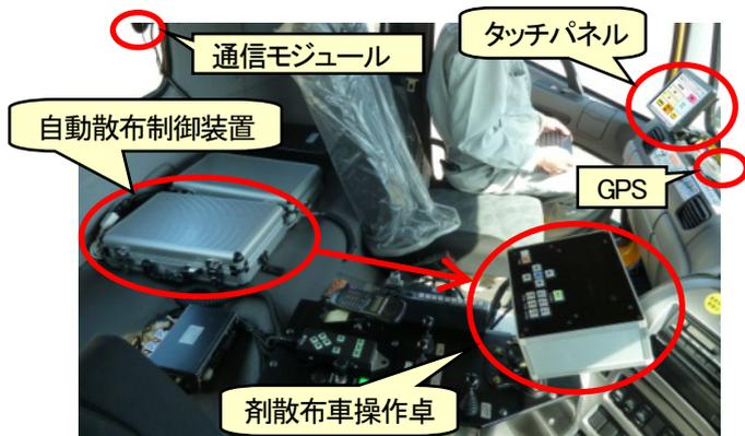
図4 凍結防止剤自動散布装置搭載状況
