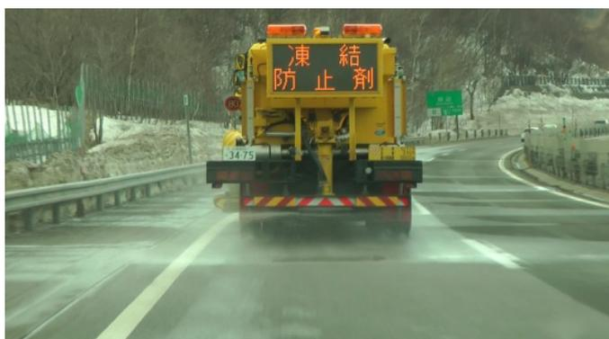
図8 浸み出し箇所への自動散布状況
