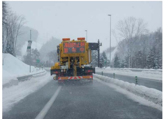
（写真2）凍結防止剤散布作業
