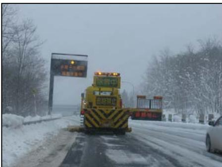
写真－２ 遮断機付き除雪車状況
