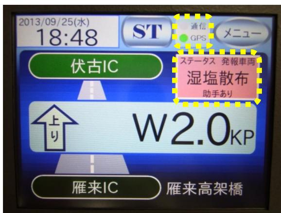
全ての操作完了後「●GPS 通信」と「作業内容（画面では湿塩散布）」を確認し作業開始
