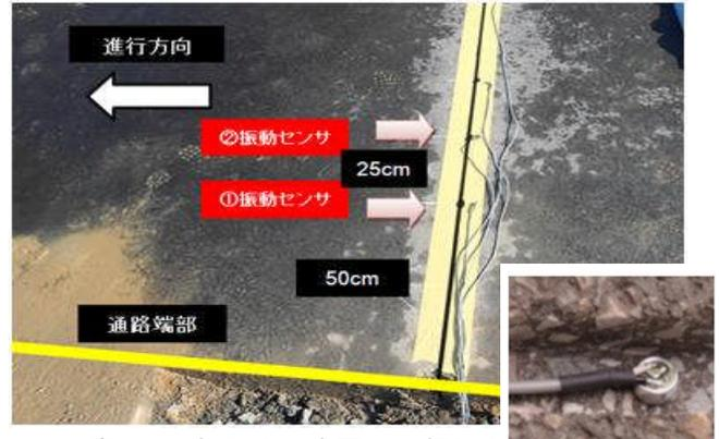
写真5 判定場所の路面への振動センサの設置状況
