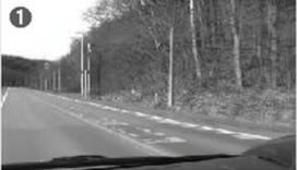
① 舗装の打ち継ぎは、揺れ、振動が大きいため脳疾患搬送時は注意を要する
