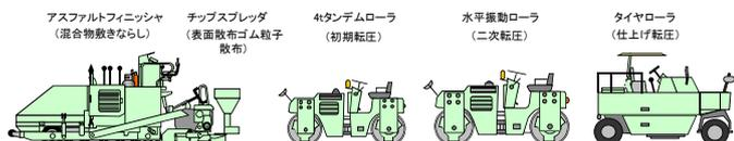
図-5 ポーラス混合物型の施工機械編成例
