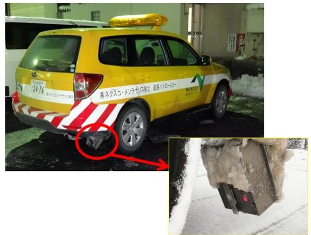
写真1 ー システム搭載車と塩分濃度センサ
