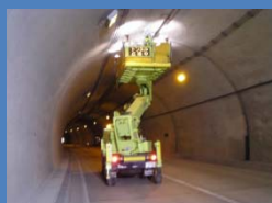
トンネル点検車
