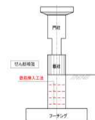
鉄筋の挿入により 耐震性能の確保を図る
