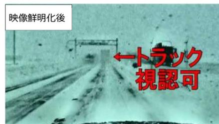
ホワイトアウト時でも 約100m先まで視認可能。吹雪時の除雪作業の継続が可能となり天候回復後速やかに通行を再開
