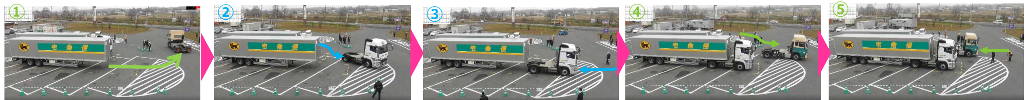
トレーラヘッド交換の状況
