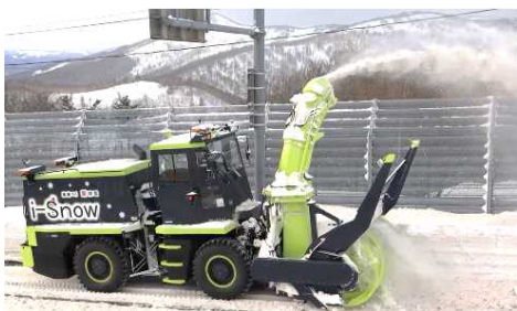
ロータリ除雪車の投雪作業自動化実証実験
