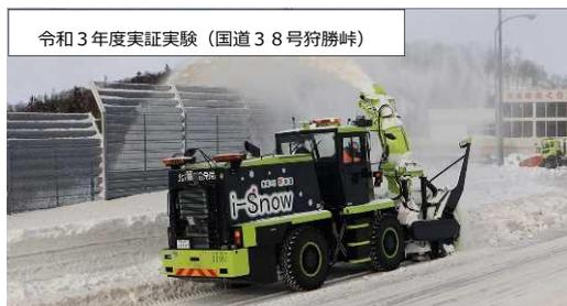
ロータリ除雪車 投雪作業自動化
