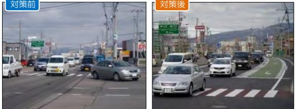
【左折車両と直進車両を分離する左折車線設置の例】
