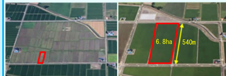
ほ場の大区画化の例 (左:整備前、右:整備後)
