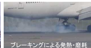
ブレーキングによる発熱・磨耗
