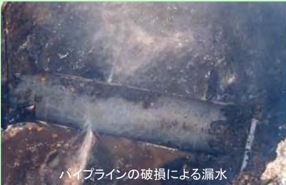
パイプラインの破損による漏水
