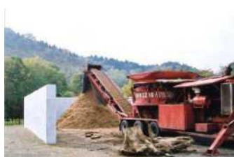
ダム貯水池で集積した流木をチップ化し園路整備として利用
