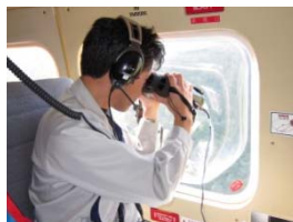
土砂災害等の被災規模を上空から計測する機器
