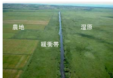
関係者間の連携により緩衝帯を設置し、農地の排水と湿地の環境保全を両立 【国営総合農地防災事業】
