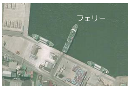
貨物船の間での不安定な縦付け係留（函館港）
