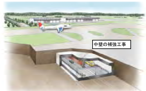
新千歳空港 耐震対策（補強イメージ図）
