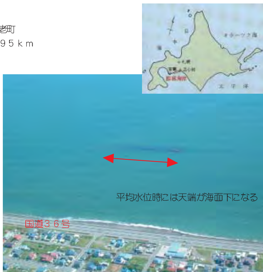
白老工区人工リーフと背後の海岸へ戻り始めた砂浜
