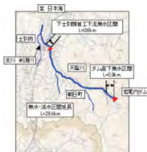
岩尾内ダム下流の無水・減水区間の現状
