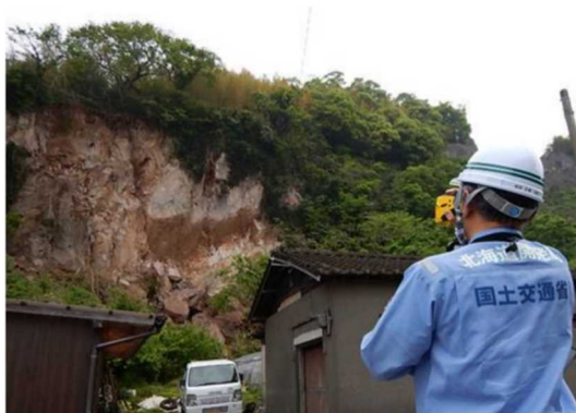
図－7 熊本地震にてレーザー距離測定器を活用し被災状況調査を実施する開発局の TEC-FORCE 隊員
