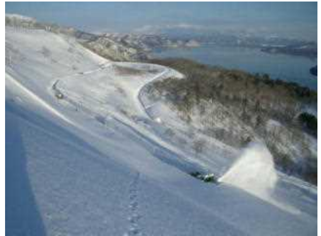
図－37 通行止めとなった国道243号美幌峠を釧路側から除雪するロータリー除雪車
