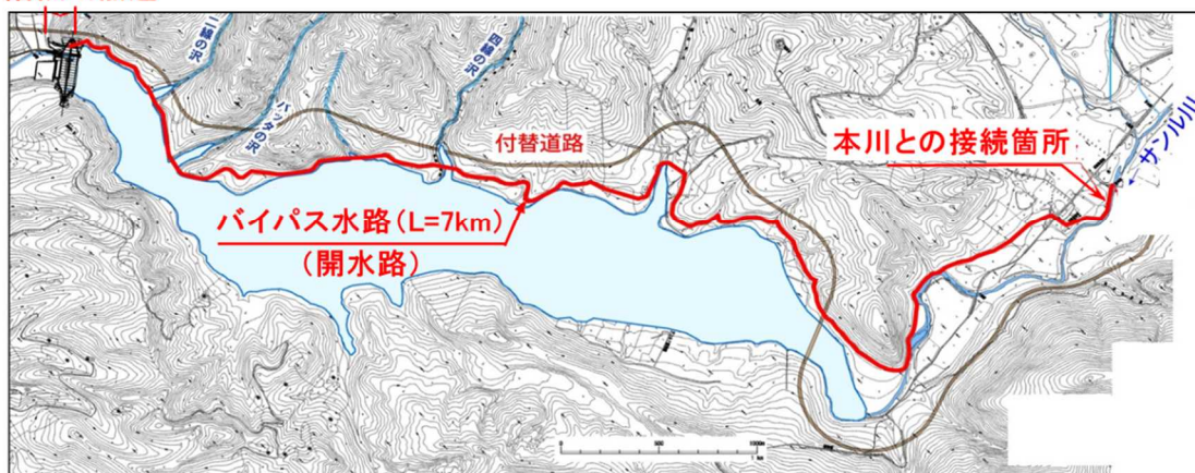
図 3-1-3-50 サンルダムの魚道
