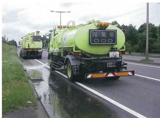
写真8 路面清掃車による清掃
