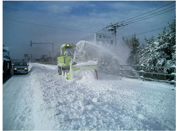
写真8 ロータリ装置による歩道除雪
