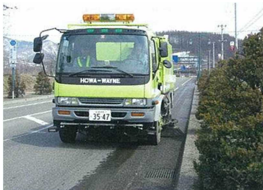
写真6 道路清掃（路面清掃）
