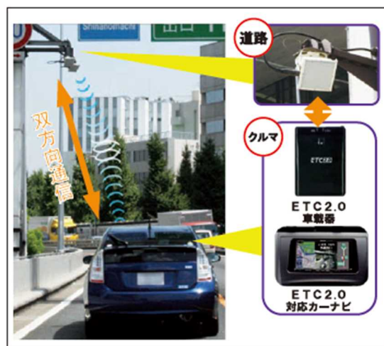
図3 ETC2.0 サービスの仕組み
