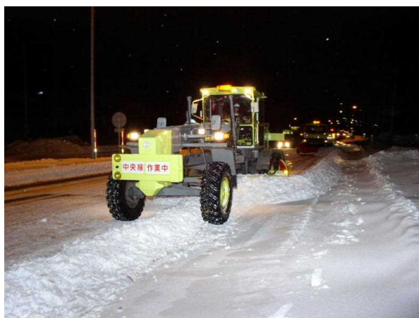
写真2 除雪グレーダによる新雪除雪
