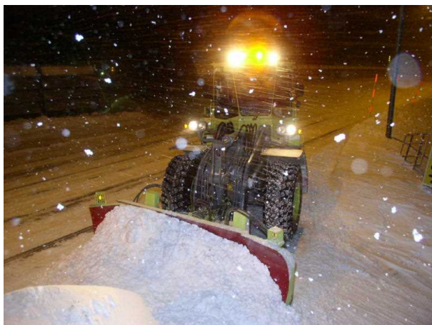
写真 10 除雪ドーザによる交差点の除雪
