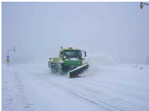
写真1 除雪トラックによる新雪除雪
