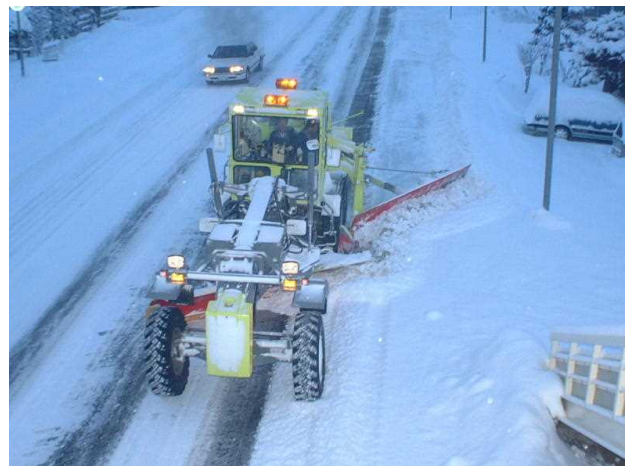
写真9 サイドウイングによる歩道除雪
