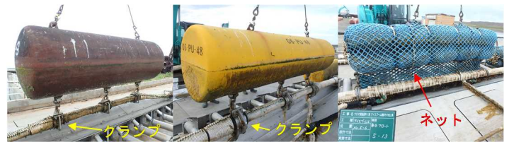
図-9 フロート(左：鋼製、中央：樹脂製、右：浮子製)
