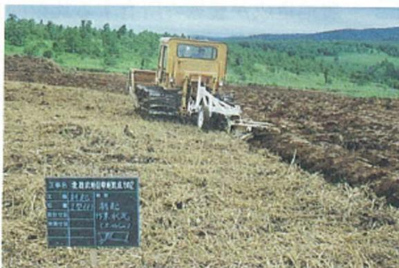
写真-36 大型プラウによる反転耕起作業
