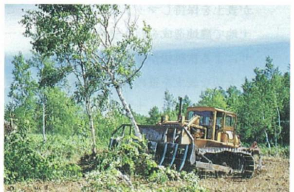
写真-34 抜排根の機械施工（レーキドーザー）
