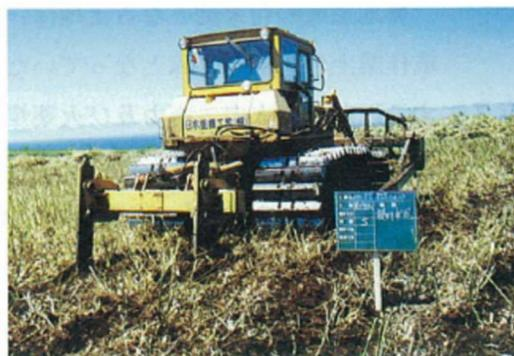
写真-37 特殊リッパーによる笹根切断作業
