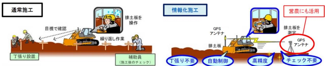
図-39 従来の施工と情報化施工（建設機械の自動制御）の比較
