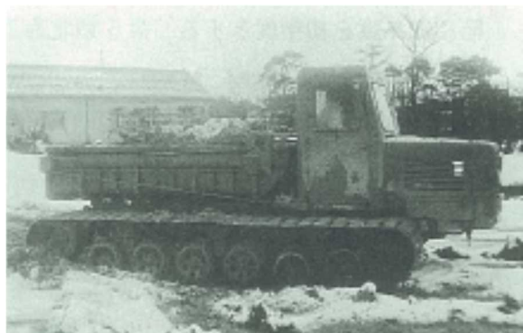
図-2 湿地用クローラダンプ
