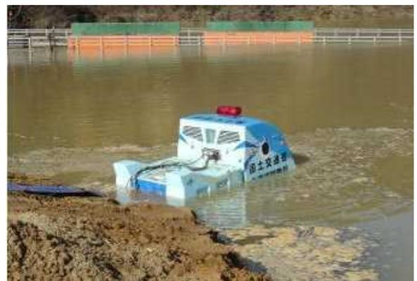
図-91 排水ポンプ自走装置(半没水式)
