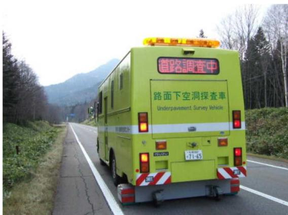
図-61 路面下空洞探査車(一次探査車)
