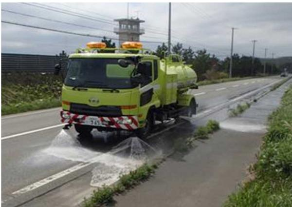
図-49 散水車による路面清掃
