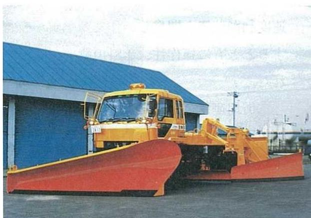
図-68 10t 除雪トラックの G ブレードとサイドウイング
