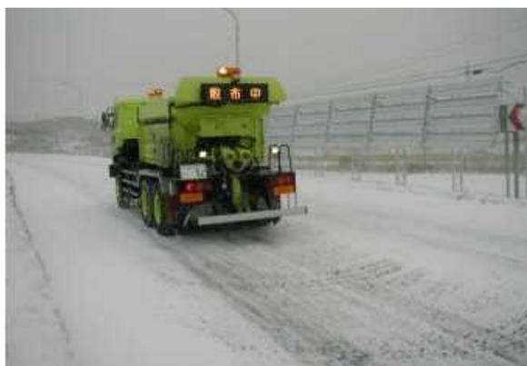
図-86 凍結防止剤散布車(専用車)
