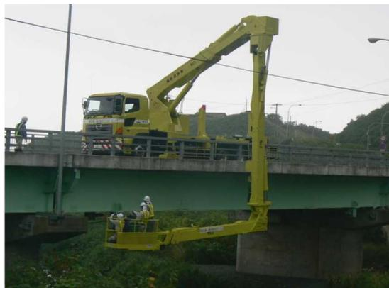
図-58 橋梁点検車(バケット式)
