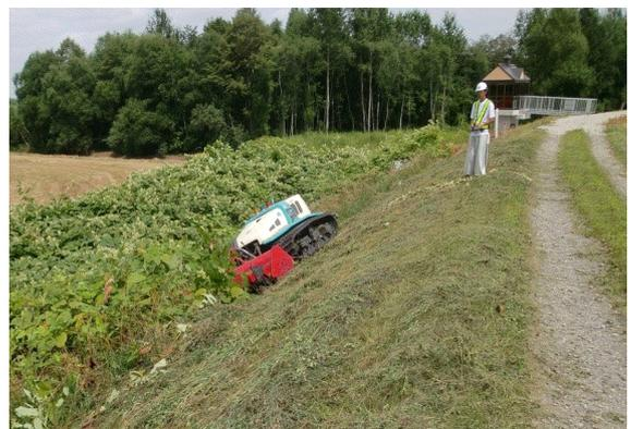
図-41 大型遠隔操縦式草刈機
