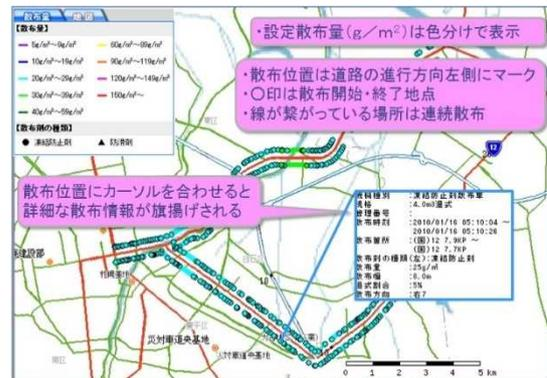
図-89 除雪機械マネジメントシステム
