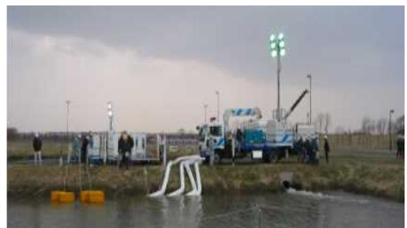
図-92 多機能型災害対策車(排水・照明作業)
