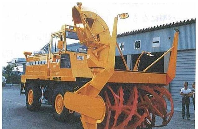
図-76 ロータリ除雪車(400ps 級)
