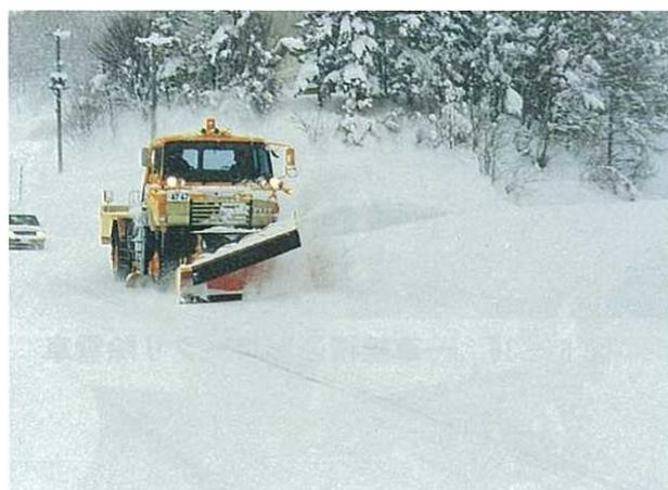
図-67 作業中の 7t 除雪トラック
