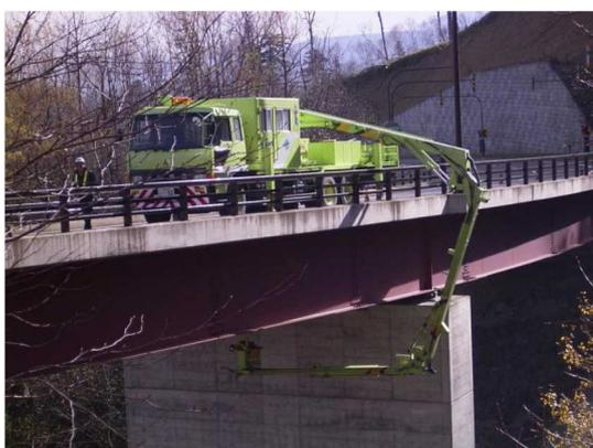
図-57 橋梁点検車(モニター式)
