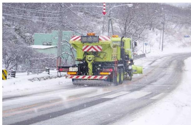
図-87 除雪トラック(散布装置付)
