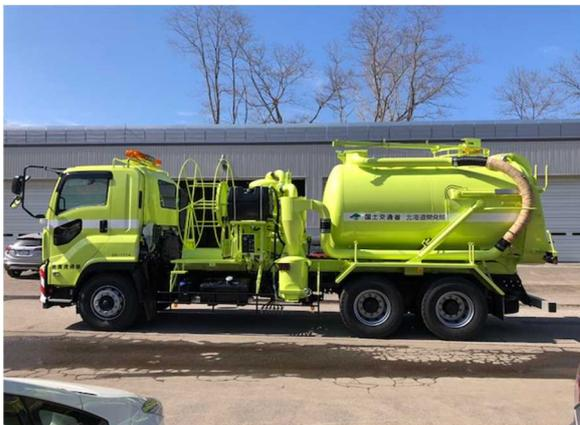
図-52 側溝清掃車(真空吸引式)
