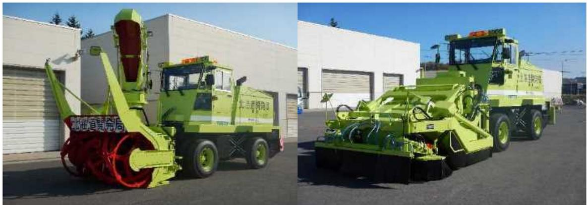
図-79 路面清掃装置付ロータリ除雪車
