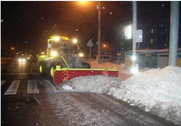
図-73 Uブレードによる抱え込み
