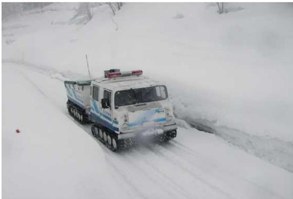
図-104 雪上走行中の水陸両用車(履帯式)
