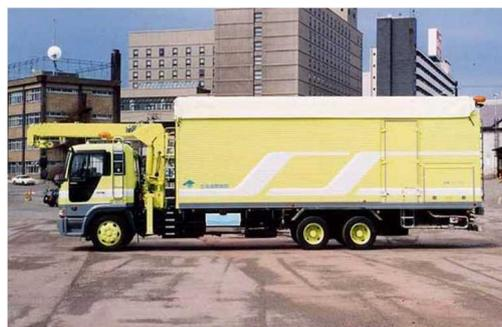
図-56 汚泥処理車(重力脱水式)
