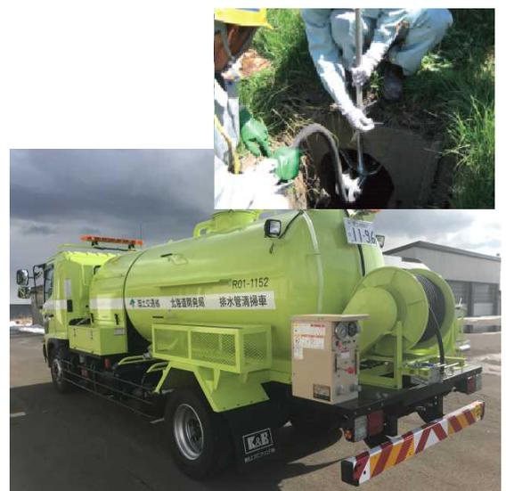
図-51 排水管清掃車及び作業
