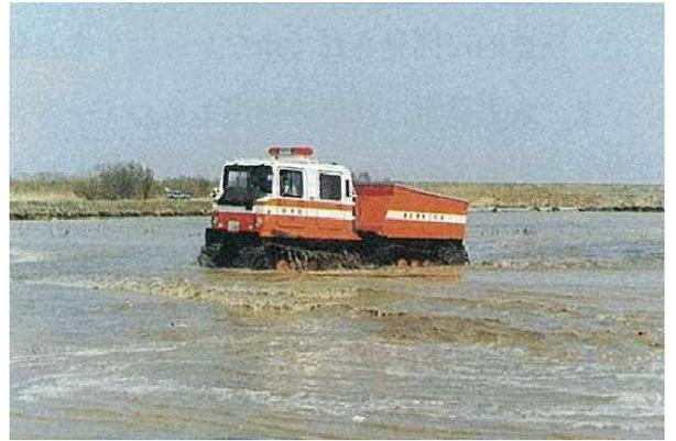
図-103 渡河中の水陸両用車(履帯式)
