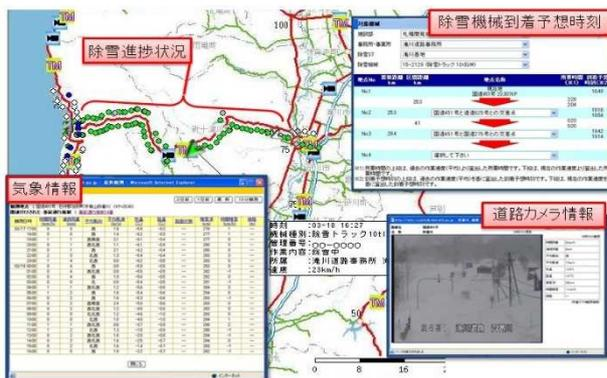
図-88 除雪機械マネジメントシステム
