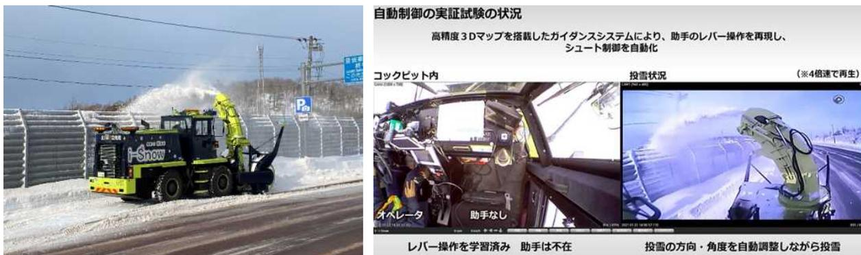
図-80 狩勝峠での習い制御試験状況
