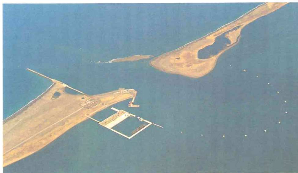
サロマ湖漁港の全景（夏期） アイスブームとその保管施設等の関連施設の状況です。流水が接岸する時期ではないため、アイスブームは設置されていません。
