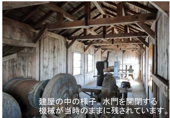
建屋の中の様子。水門を開閉する機械が当時のままに残されています。
