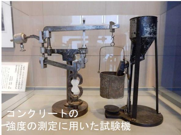
コンクリートの強度の測定に用いた試験機
