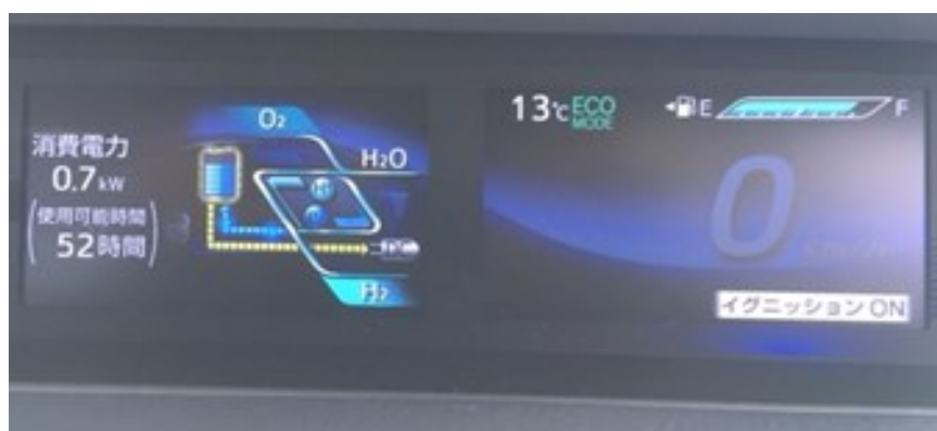
給電中の車内ディスプレイ(給電モニター)
