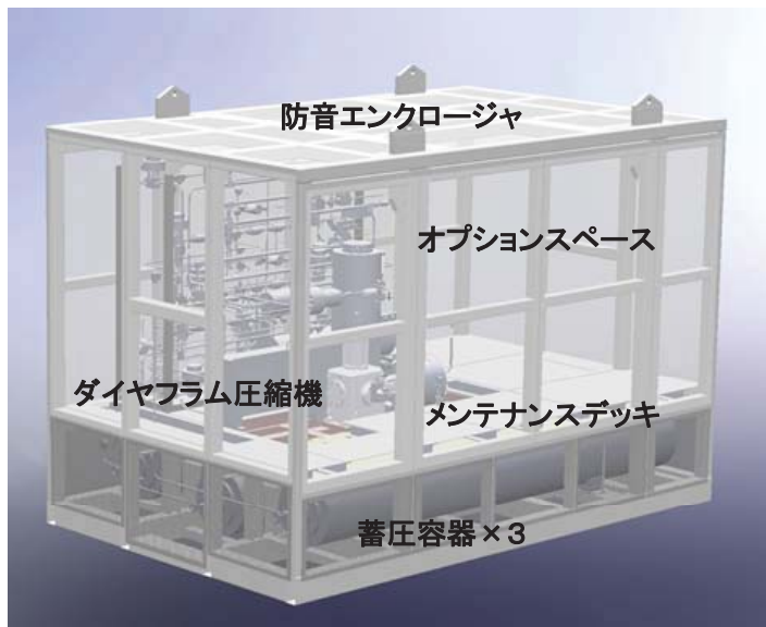
図 JSW小型パッケージユニット L4.4m × B2.9m × H3.2m
