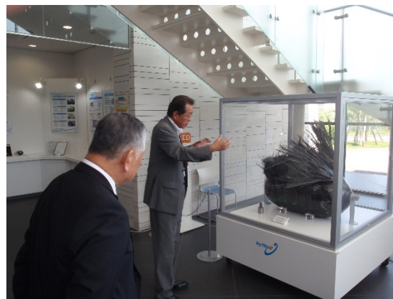
水圧破裂試験後の容器
