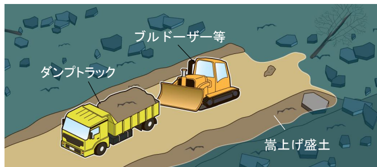
図 4-6 浸水対策班の作業イメージ
