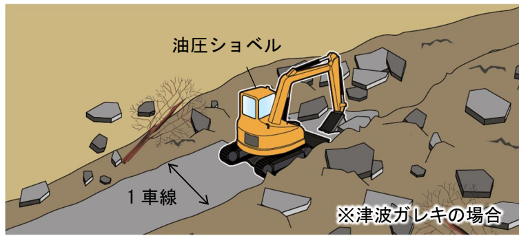
図 4-5 ガレキ撤去班の作業イメージ
