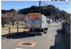
(空洞探査車による調査)
