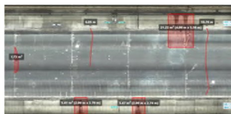
覆工展開画像から損傷図を作成
