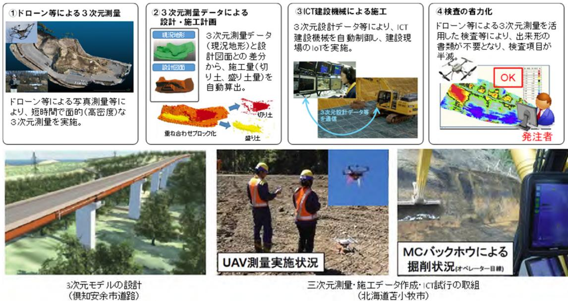
図 110 i-Construction の推進 (BIM/CIM の活用、ICT 土工)
