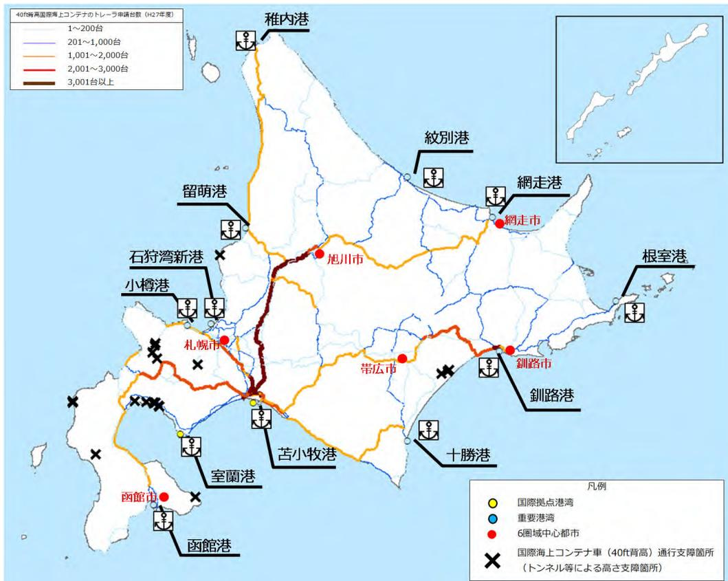
図42 40ft背高国際海上コンテナの主要経路と通行支障箇所
