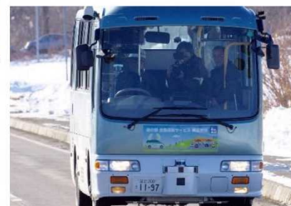
路面に埋設した磁気マーカーの読み取りによる自動走行（運転手不在）
