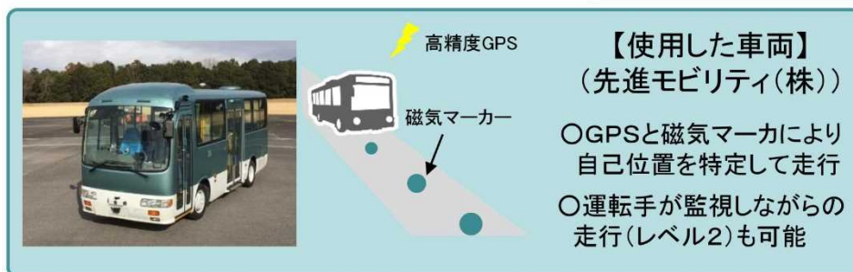
路面に埋設した磁気マーカーの読み取りによる自動走行（運転手不在）
