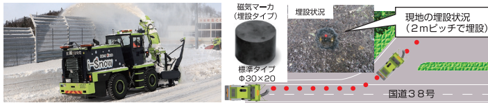
▲国道38号 狩勝峠ロータリ除雪車実証実験 ▲不感地帯対策(例：磁気マーカーシステム)
