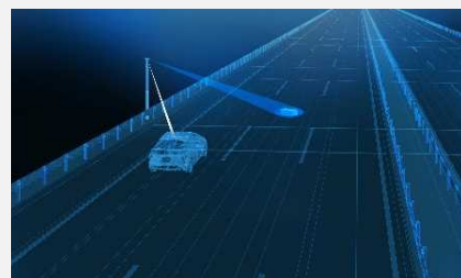
センサによる落下物等の検知 路車間通信による情報提供
